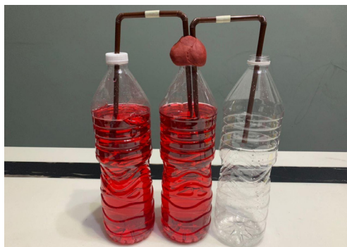
Rajah 6.4: Air berwarna merah dimasukkan ke dalam dua botol yang bertutup sehingga 80 peratus penuh. Botol ketiga dibiarkan kosong. Straw dimasukkan ke dalam botol berdasarkan rajah di atas. Plastisin diletakkan pada penutup botol kedua bagi memastikan ia kedap udara
