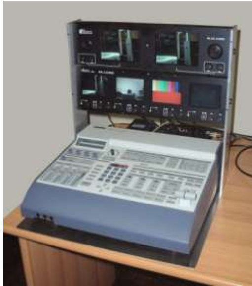
Gambar 5.25. Digital video mixer yang digunakan di STV Bandung
